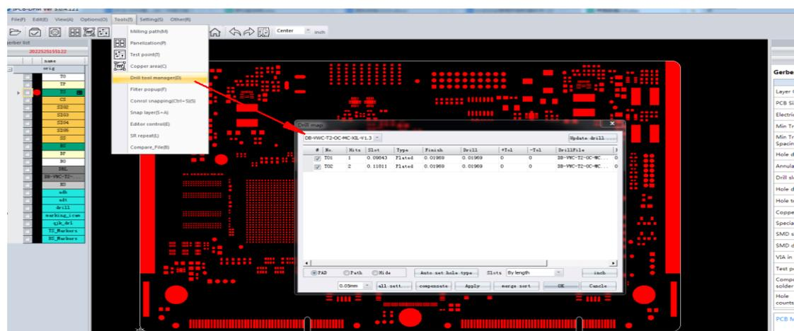
图 33-钻孔管理器//Tool management
